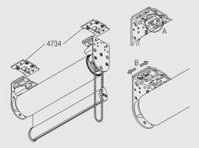
Montierte Edelstahlplatten zum Einhängen des Rollos (A) tragen das Gewicht des Systems, während der Monteur die Feineinstellung der Träger vornimmt.
