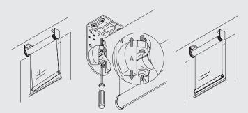
Die höhenverstellbaren Edelstahlträger ermöglichen die perfekte horizontale und vertikale Ausrichtung des Rollos bei der Installation. Hierdurch wird die Parallelität des ganzen Systems mit der Oberkante der Decke und des Stoffes mit der Fensterkante garantiert.
