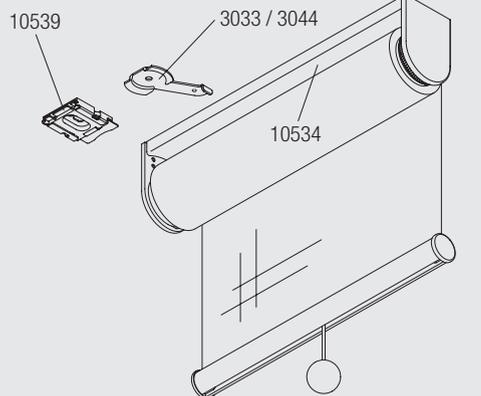
Zwecks vereinfachter Montage wird das System nur mit vormontiertem Tragprofil 10534 ausgeliefert.
