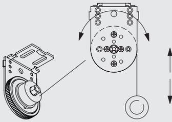
Bei fensterseitiger Abrollrichtung ist der End-Stopp auf der linken Seite eingebaut.
