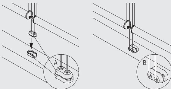
A: Befestigung der Seitenführung im Fensterrahmen
